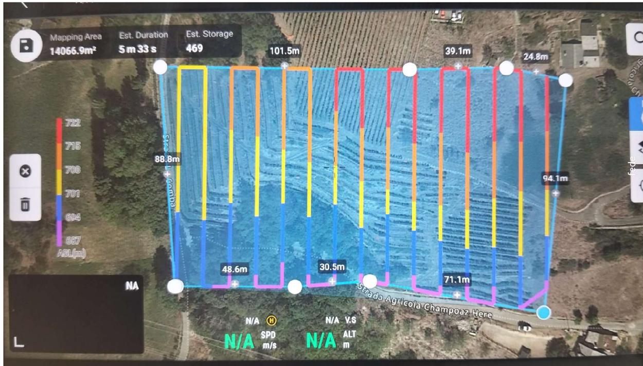
Definizione dell'area di interesse e calcolo della rotta di rilievo (terrain follow – DSM)
